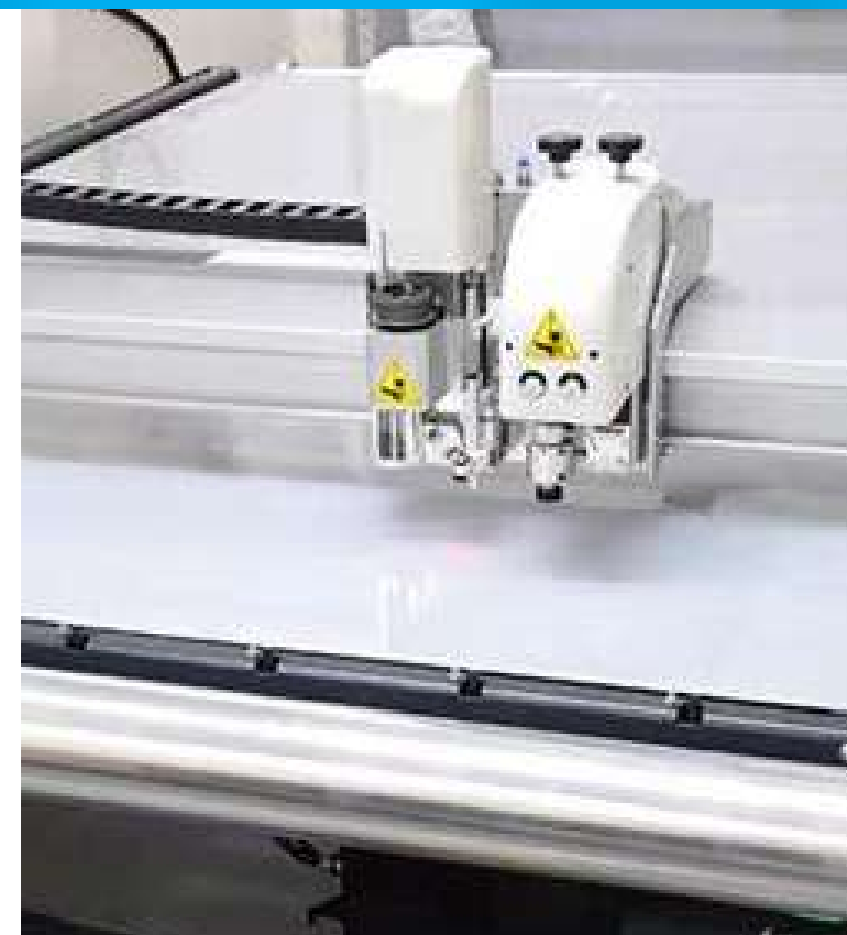
Máquina lecho - Recorte de materiais como acrílico, pvc, ps, polionda, mdf, filme back light, adesivo, papel, lona, papelão.
